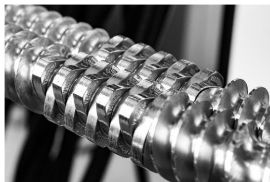
Fig 2: Exemple de profil de vis en extrusion
