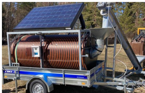
Fig 2: Päikeseenergiaal põhineva trummel-kuivati arendus
