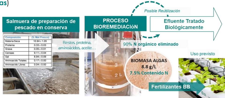
Fig 1: Diagrama que muestra el tratamiento biológico de las salmueras de la industria conservera de pescado utilizando microalgas con valor potencial para uso agrícola.
