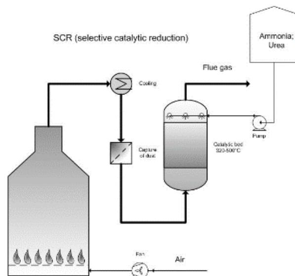
Figure I-2. Scheme SCR (Emis: energie- en milieu-informatiesysteem voor het Vlaamse Gewest n.d.)
