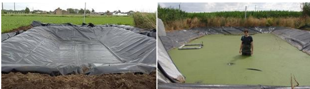
Figuur 18 Links de piloot in constructie. Rechts De piloot in werking. Een inoculatiecirkel met sensoren is links in beeld te zien, centraal wordt er toegezien op de skimmer die het eendenkroos oogst. Op de achtergrond zijn nog een deel van de netten te zien, aan de staalkabels werden ook de densiteitsmeters geplaatst
