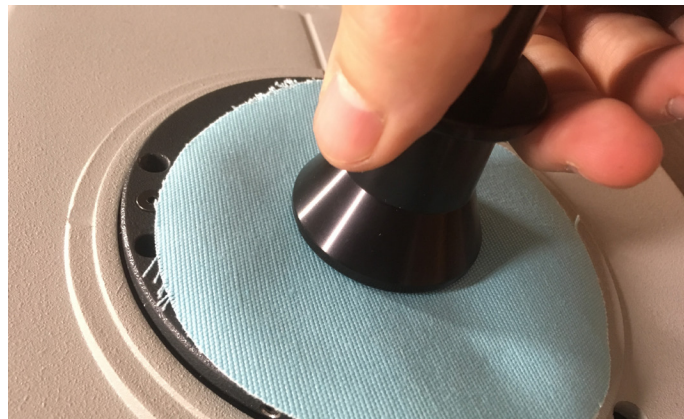
Figuur 3: Kleurbepaling met spectrofotometer
